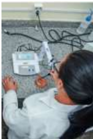
Figura 7 – Estudante no laboratório de Química utilizando o peagômetro para determinar o valor de pH de uma solução.
