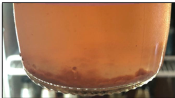
Figura 1 – Imagem exemplificativa do resíduo depositado no fundo dos recipientes de armazenamento.
