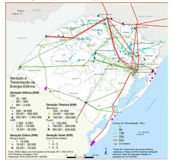
Figura 2 – Geração e Transmissão de Energia Elétrica no Rio Grande do Sul
